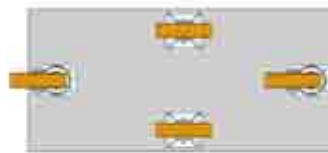
两个万向脚轮和定向脚轮，其中定向脚轮具有略高的结构高度
