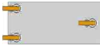
具有相同结构高度的三个万向脚轮
