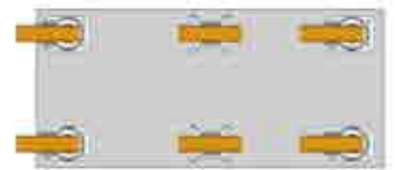
具有相同结构高度的四个万向脚轮和两个定向脚轮
